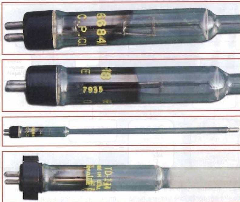
foto 3: i tubi a gas utilizzati dalle varie case: quello della cp Clare (sorgente Sanders) e della Signalite (ultima foto in basso)
